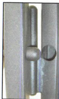
Cerniera apertura esterna con piolo di sicurezza saldato che garantisce maggiore sicurezza in fase di chiusura dell'inferriata, dovuto alla penetrazione del piolo nel montante fissato alla muratura
